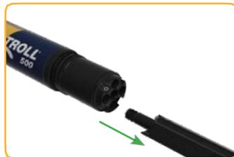
Falls vorhanden, den Stecker des Sensoranschlusses entfernen. Nicht verdrehen.
