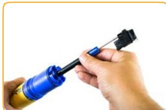
Um kristalline Ablagerungen zu entfernen, reinigen Sie den Sensor mit warmem Wasser und Seife oder legen Sie ihn für 10 bis 30 Minuten in eine 5%ige HCl-Lösung.
