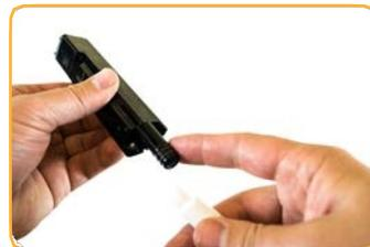
Schmieren Sie den O-Ring an der Unterseite des Sensors.
