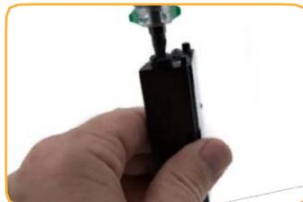
Leicht überfüllen. Setzen Sie die Referenzverbindungskappe wieder ein und ziehen Sie sie fest, bis sie das Sensorgehäuse berührt.
