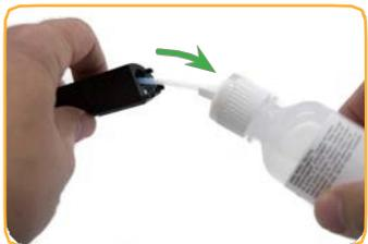
Drücken Sie einen gleichmäßigen Strom der Lösung in das Reservoir, während Sie den Schlauch langsam herausziehen.
