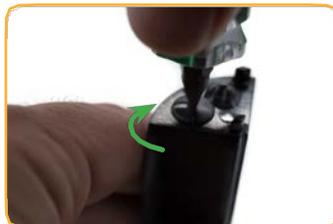
Drehen Sie die Kappe um weitere 90° (eine Vierteldrehung), um sie zu sichern.
